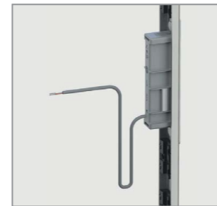
RIEGELSCHALTKONTAKT RSK2 Im obere Schließblech eingebaut. Wird durch den Schwenkriegel des Türschlosses betätigt. Rückmeldung: Tür manuel oder mechanisch abgeschlossen!
